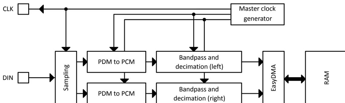
Figure 70: PDM module
