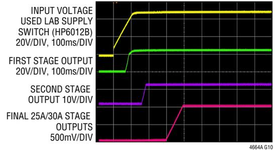
48V TO 1V AT 0A LOAD, EACH 25A/30A STAGE
