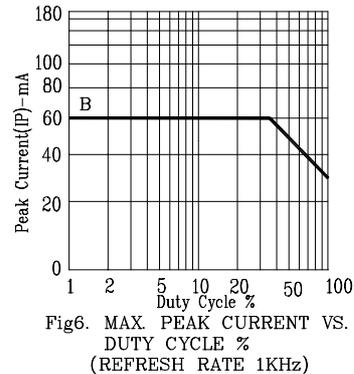
Fig6. MAX. PEAK CURRENT VS. DUTY CYCLE % (REFRESH RATE 1KHz)
